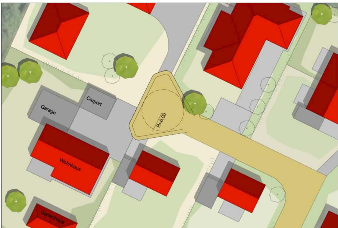
Abb. 7: Wendeanlage (Bild 59, RAST06)
